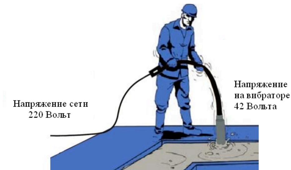
Рис.3 Высокочастотный вибратор STP со встроенным преобразователем
