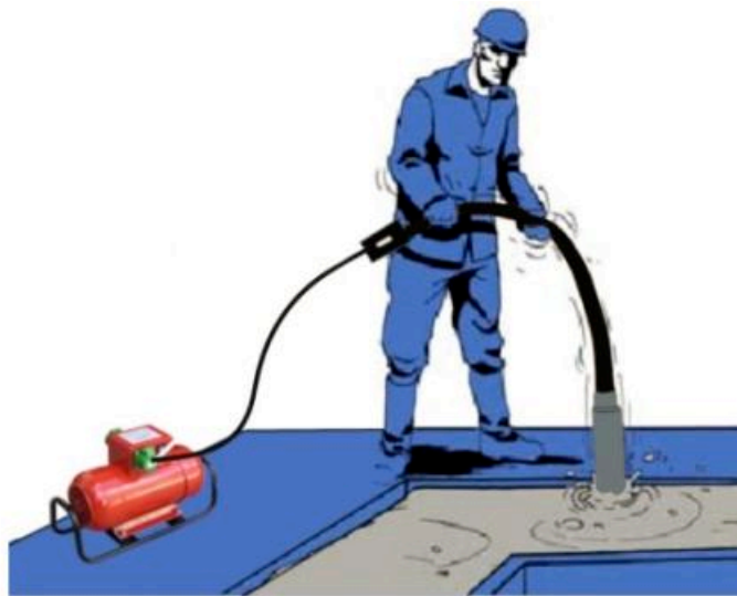
Рис. 2 Высокочастотный вибратор, подключаемый к преобразователю
